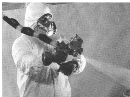
Рисунок 2.5 – Напыление детали связующим с рубленными волокнами ровинга
