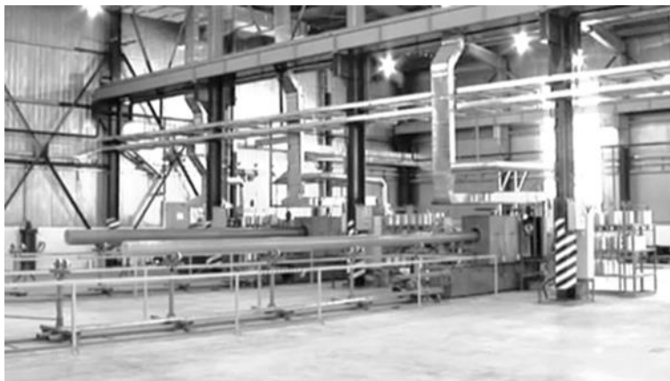
Рисунок 2.53 – Участок изготовления труб способом КППН со самосталкивающей оправкой
