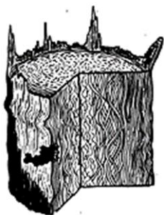
Рисунок 1.2 – Трехмерная структура ПАН волокна диаметром 8 мкм
