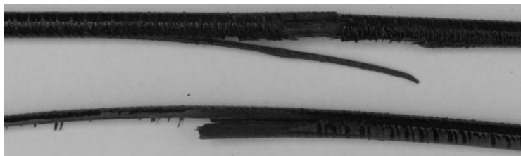
Рисунок 5.1 – Вид образцов эпоксидного базальтопластика аминного отверждения после испытаний на продольный изгиб при выдержке в 10 % HCl при 55 °C в течении 90 суток
