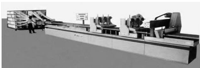
Рисунок 2.16 – Вид промышленной пултрузионной линии для получения профилей большого сечения. На заднем плане шпулярник На переднем плане отрезное устройство и тянущий механизм перехватывающего типа
