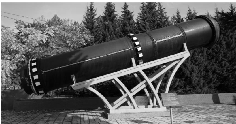
Рисунок 6.5 – Стратегическая твердотопливная ракета Р-39 с корпусом из органопластика и сопловым блоком из материала углерод-углерод
