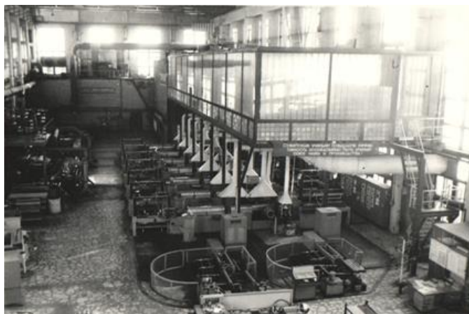
Рисунок 2.52 – Поточная линия изготовления корпусов для противораковых ракет «Облако» в НПО «Алтай». На переднем плане механизм распрессовки и возврата оправок
