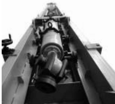
Рисунок 3.20 – Стапель-съёмник для распрессовки изделий с оправки
