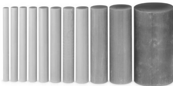
Рисунок 2.22 – Стержни из стеклопластика диаметром 10-80 мм полученные на линии по схеме рисунка 2.21. Кольцевая оплетка снята
