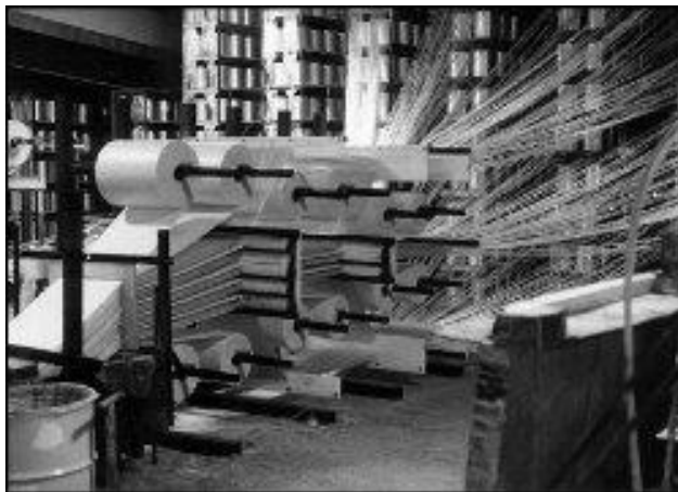
Рисунок 2.18 – Внешний вид шпулярника для подачи армирующих материалов к пултрusionной линии для получения изделий большого сечения. Используются ленты и ровинги
