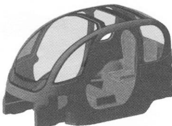
Рисунок 6.17 – Блок корпуса электромобиля, выполненный из углепластика
