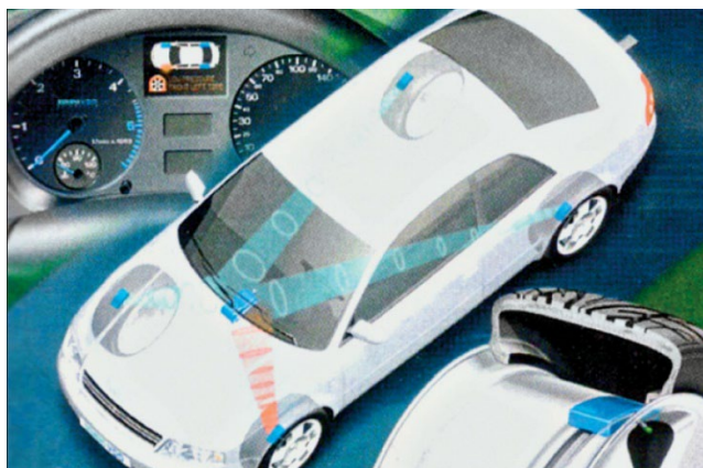
Рисунок 29 - Система производства компании Siemens постоянно контролирует давление воздуха в шинах посредством датчиков, установленных в колёсах.
