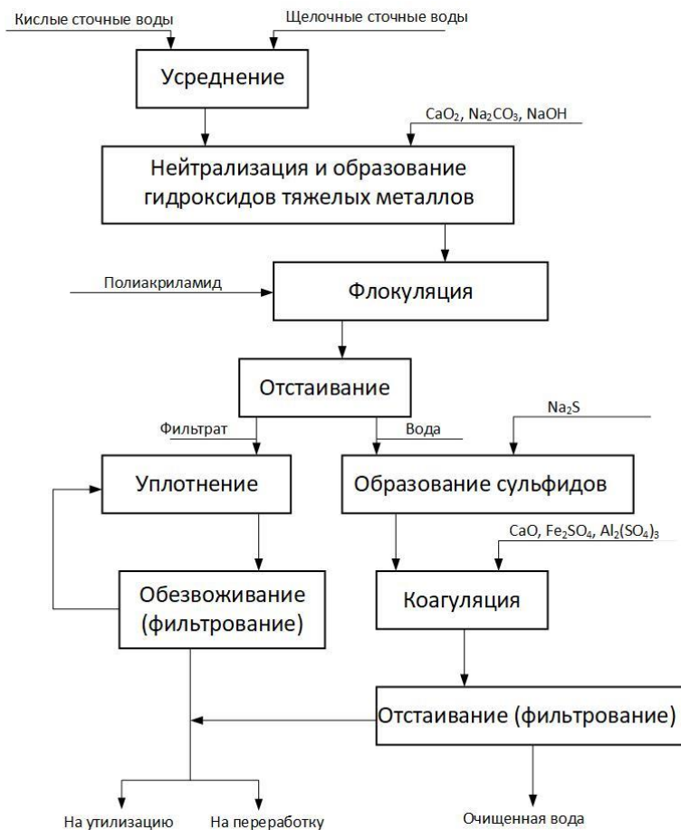
Рисунок 17 – Схема реагентной очистки сточных вод от ионов тяжелых металлов
