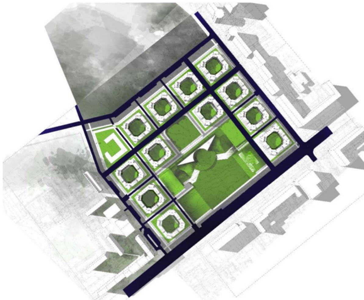
Рис. 48 – Квартальная застройка микрорайона с пешеходными улицами (выделены серым). Решение дипломницы Островской Дарьи, рук. М. П. Диндиенко, ИНАрхДиз АлтГТУ, 2016 г. [36].
