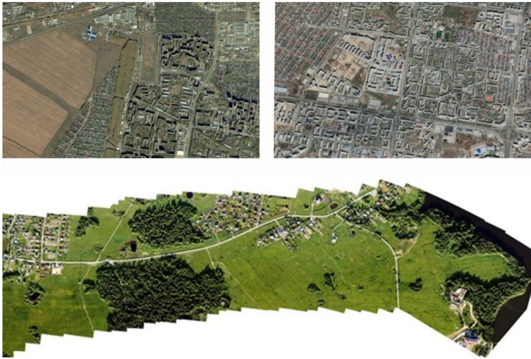
Рис. 33 – Примеры аэрофотосъёмки из банков данных (слева – Яндекс Карты, справа – GoogleEarth). Внизу – пример орфтоплана [82]
