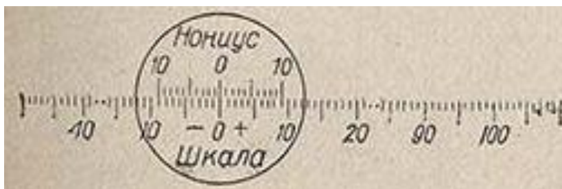
Рисунок 17 – Шкала и нониус сахариметра
