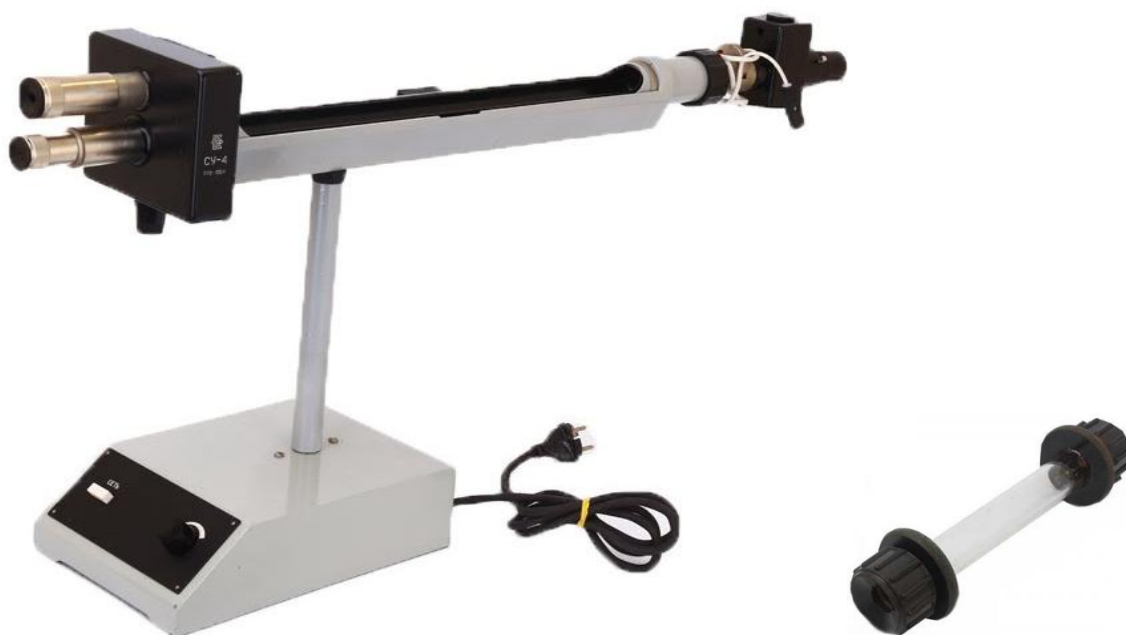
Рисунок 16 – Сахариметр СУ-3 и кювета к нему (справа)
