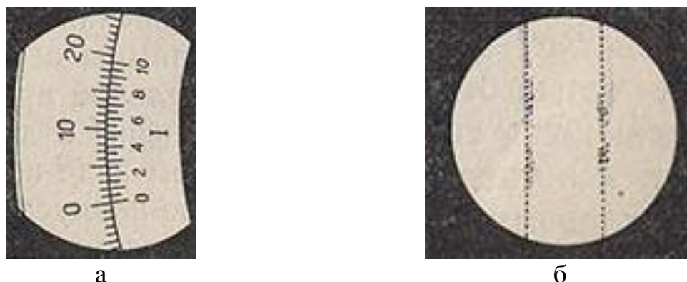
Рисунок 15 – Начальное положение нониуса шкалы (а) после установки поля зрения на равную затемнённость (б)
