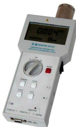
Рисунок 3.1 – Измеритель параметров электростатического поля ИПЭП-1
