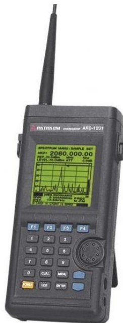
Рисунок 3.6 – Внешний вид анализатора спектра АКС-1201
