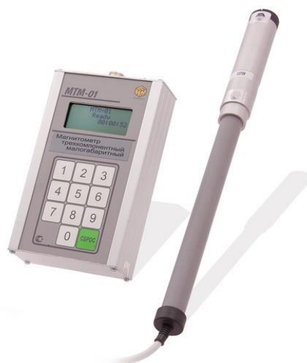
Рисунок 3.2 – Измеритель постоянного магнитного поля МТМ-01
