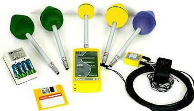
Рисунок 3.4 – Измеритель электромагнитного излучения ПЗ-41
