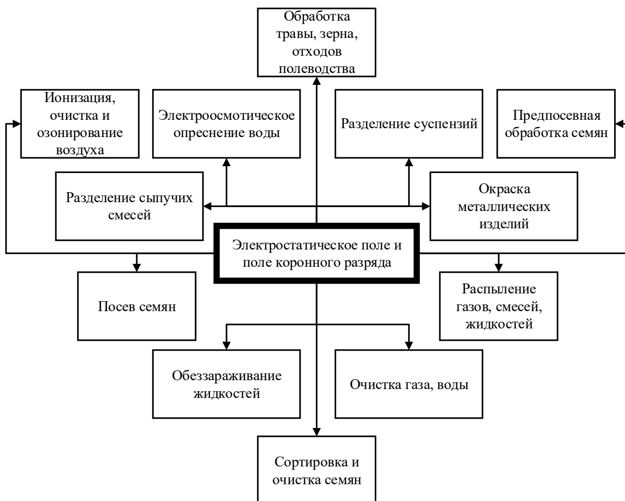
Рисунок 1.1 – Электротехнологические процессы при использовании электростатического поля и поля коронного разряда
