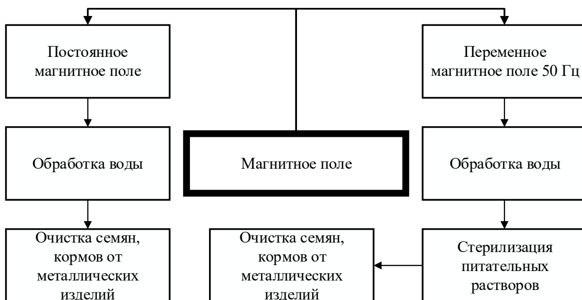
Рисунок 1.3 – Электротехнологические процессы при использовании магнитного поля
