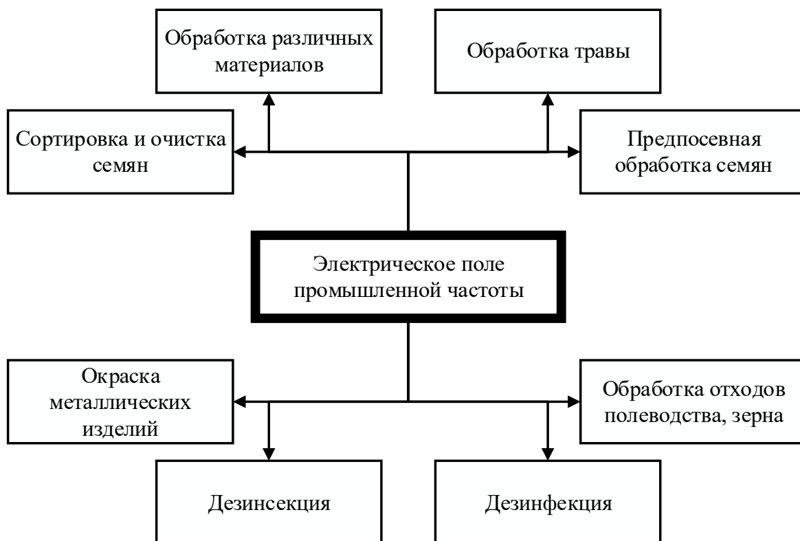
Рисунок 1.2 – Электротехнологические процессы при использовании электрического поля 50 Гц
