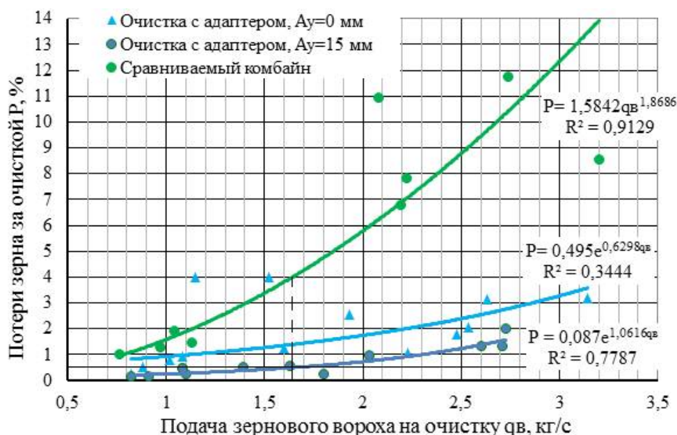
Рисунок 5.6 – Результаты сравнительных полевых испытаний зерноуборочного комбайна с адаптером очистки для склонов
