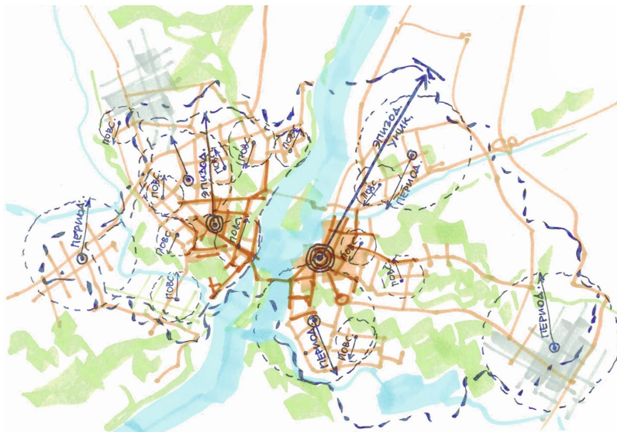
Рисунок 3.3.1 – Радиусы обслуживания предприятий в соответствии с концепцией ступенчатого обслуживания населения.
