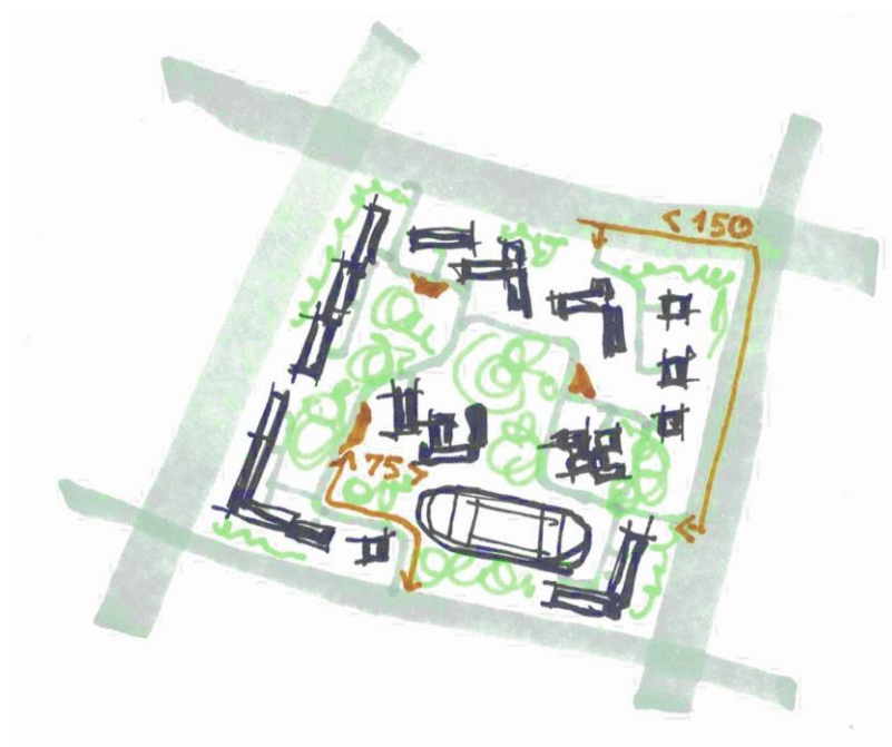
Рисунок 6.4.3 – Базовые размерности системы локальных проездов в единице планировочной структуры с примером размещения разъездных площадок.
