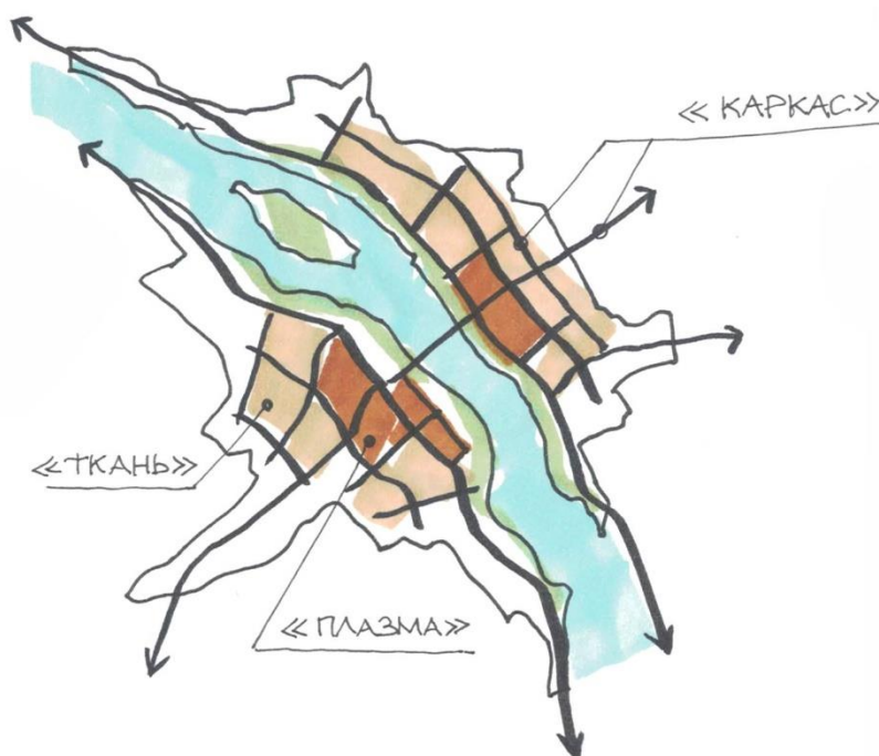
Рисунок 1.2 – Структура градостроительной системы (на примере города).
