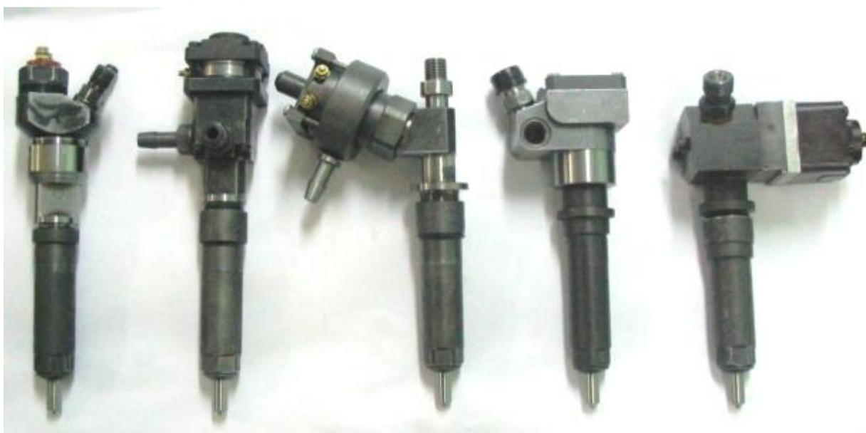
Рис. 5.12 – Насос-форсунки АЗПИ. Крайняя справа – первый вариант с электромагнитов ППП «Дизельавтоматика» (система «СЭМА»), в центре – вариант, прошедший моторные испытания, крайняя слева – последний вариант («7407»)
