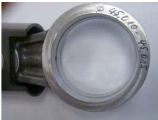
Рис. 4.27 – Кривошипно-шатунный механизм ТНВД HEINZMANN
