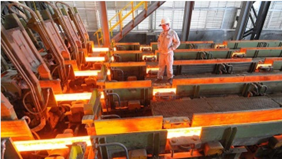
Stähle werden aus **Roheisen hergestellt**. Das **Roheisen** selbst wird im Hochofen aus **Eisenerzen gewonnen**. **Roheisen enthält** neben dem **Hauptbestandteil** Eisen etwa 4% Kohlenstoff und unerwünschte oder **zu hohe Mengen** der **Begleitstoffe** Silicium, Mangan, Schwefel und Phosphor. Bei der Umwandlung von **Roheisen** in Stahl müssen der **Kohlenstoffgehalt herabgesetzt** und die unerwünschten **Begleitstoffe fast ganz beseitigt** werden. Diesen **Vorgang** nennt man **Frischen**.
