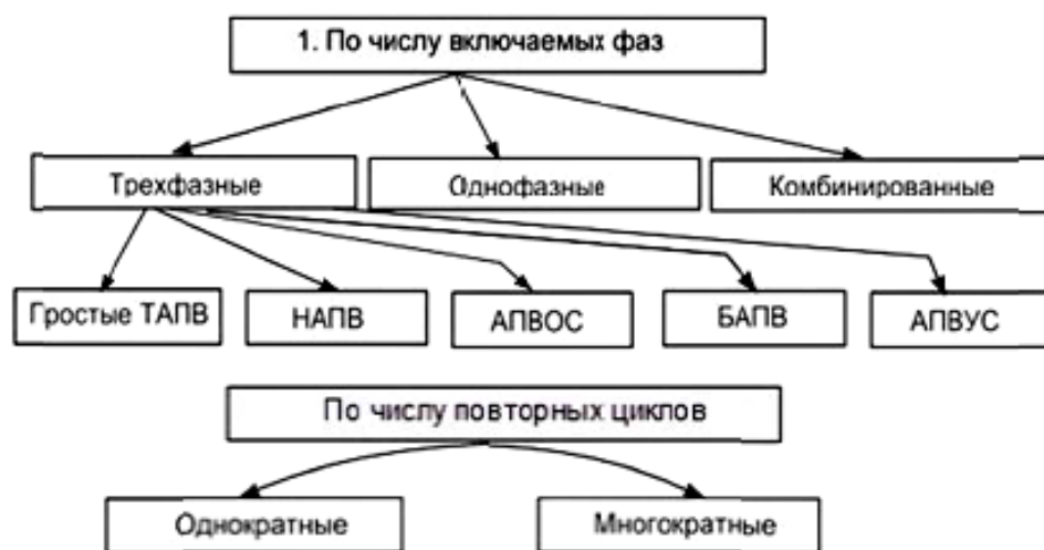
Рисунок 58 – Классификация устройств автоматического повторного включения
