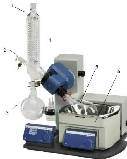
1 – обратный холодильник; 2 – сброс вакуума в системе; 3 – колба-приёмник; 4 – двигатель; 5 – круглодонная колба; 6 – водяная баня
