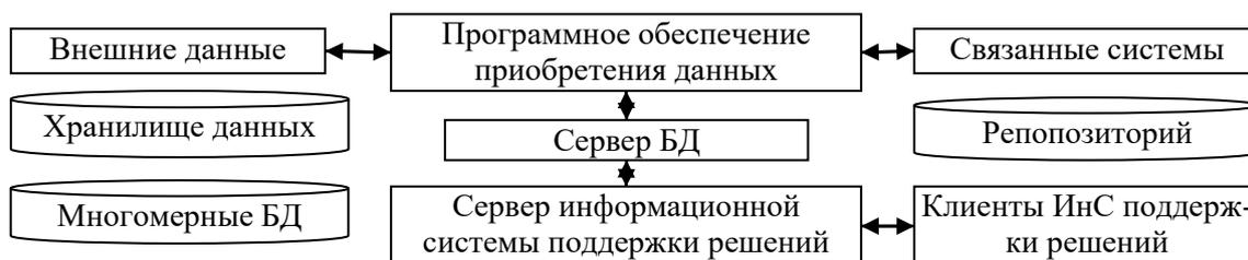
Рисунок 3.2 – Трехрядная архитектура хранилища данных
