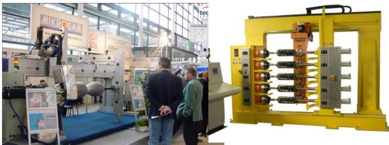
Рисунок 7.3 – Станок с вынесенным приводом вращения, используется для намотки изделий сложной геометрической формы (а); пятишпindelный намоточный станок рамного типа, предназначен для одновременной намотки пяти изделий (б)
