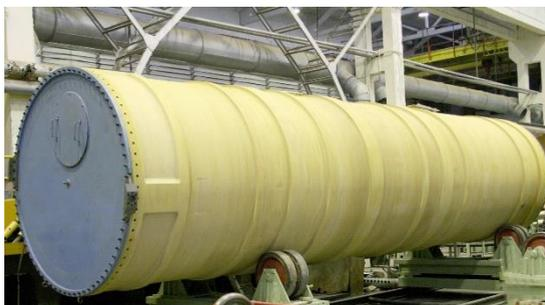
Рисунок 1.11 – Композитная цилиндрическая оболочка – контейнер для твердотопливной баллистической ракеты
