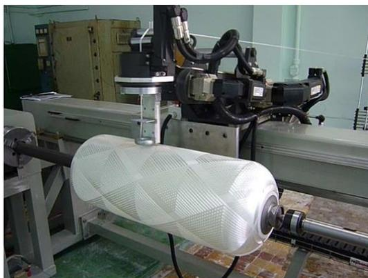
Рисунок 7.5 – Четырехкоординатный намоточный станок для изготовления баллонов давления методом мокрой намотки
