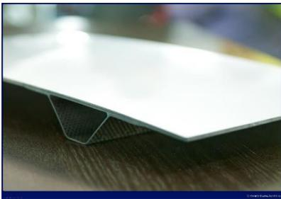
Рисунок 2.4 – Композитная панель как деталь корпуса современного самолёта
