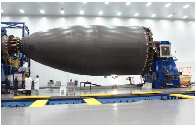
Рисунок 1.3 – Секция фюзеляжа пассажирского лайнера Боинг-787, изготовленная методом намотки
