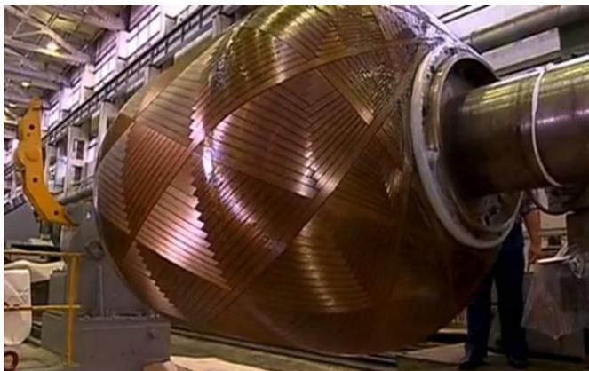
Рисунок 1.10 – Баллон давления, используемый в качестве двигателя твердотопливной ракеты, изготавливается методом непрерывной намотки
