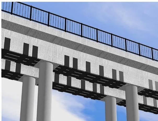
Рисунок 4.9 – Подкрепление мостовых балок углеродным волокном
