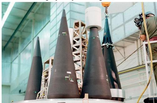
Рисунок 10.3 – Ступень разведения американской тяжелой МБР LGM0118А Peacekeeper, также известной как MX. Ракета была оснащена десятью разделяющимися боеголовками по 300 кт, снята с вооружения в 2005 году
