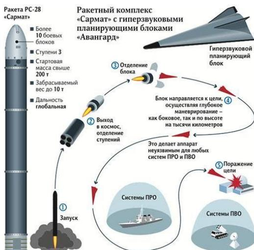
Рисунок 6.13 – Ракетный комплекс «Сармат» (РС-28) с гиперзвуковыми планируемыми блоками «Авангард»
