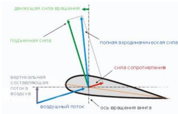
Рисунок 5.4 – Фрагмент лопасти вертолёта и действующие на лопасть усилия в плоскости лонжерона
