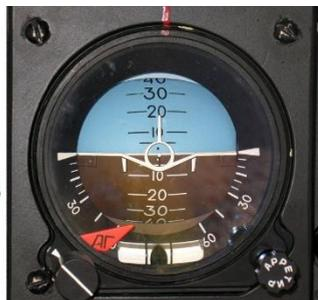
Рисунок 1.15 – Использование гироскопа с тремя степенями свободы в качестве автогоризонта воздушного судна
