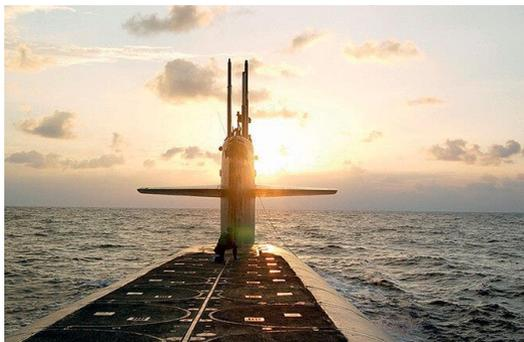
Рисунок 10.6 – Американские подводные лодки класса «Огайо» — единственный тип ракетносцев, находящийся на вооружении США. Несет на борту 24 баллистических ракеты с РГЧ Trident-II (D5). Количество боевых блоков (в зависимости от мощности) — 8 или 16
