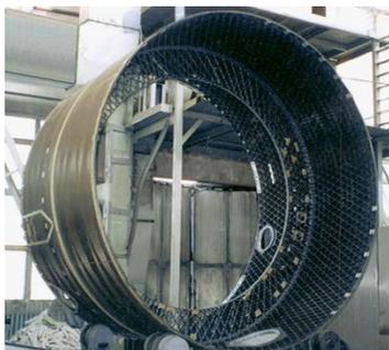
Рисунок 1.12 – Цилиндрическая композитная конструкция, подкреплённая ребристой оболочкой, предназначена для использования в ракетной технике
