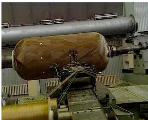
Рисунок 7.2 – Процесс намотки баллона давления «мокрым» способом
