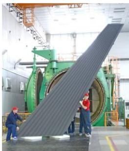
Рисунок 1.9 – Композитная панель после отверждения в автоклаве будет использоваться при изготовлении российского узкофюзеляжного самолёта МС-21
