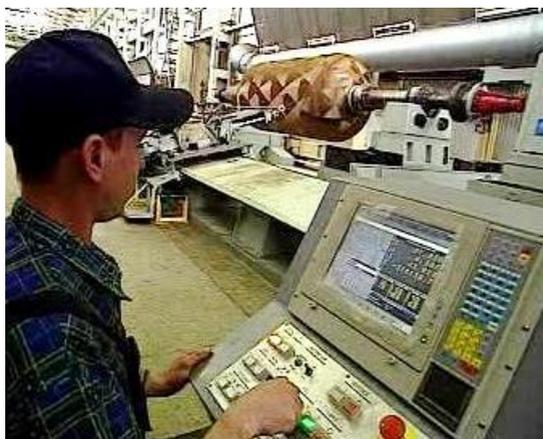
Рисунок 6.4 – «Мокрая» намотка композитного баллона
