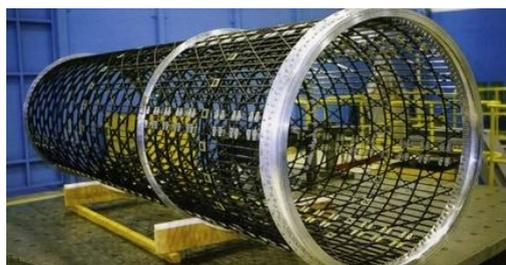
Рисунок 3.9 – Композитная сетчатая несущая конструкция (космос)
