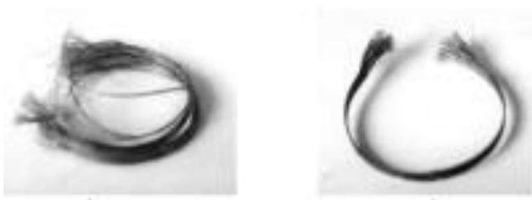
Рисунок 9.9 – Разрушение кольцевых образцов органопластика при растяжении
