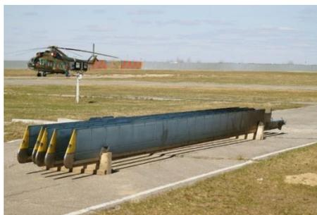
Рисунок 5.8 – Комплект лопастей несущего винта вертолета
