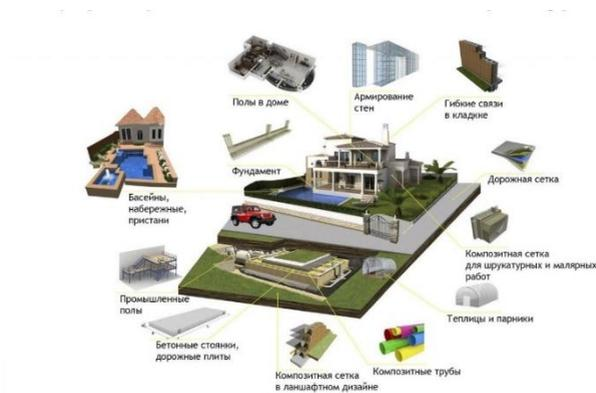
Рисунок 3.10 – Применение композитных стержней в строительстве
