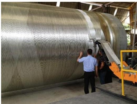
Рисунок 1.13 – Намотка цилиндрической композитной оболочки на намоточном станке FW4-600/3000 CNC Master
