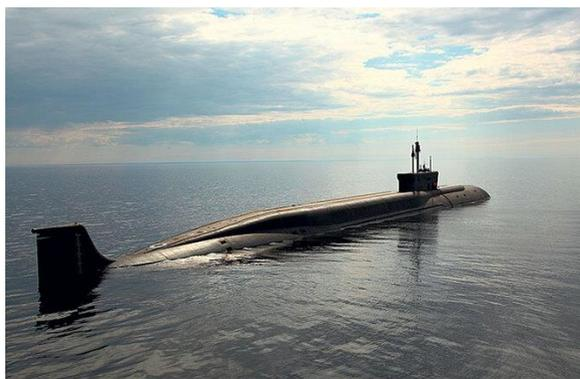
Рисунок 10.5 – Подводные лодки проекта 955 «Борей» — серия российских атомных подводных лодок класса «ракетный подводный крейсер стратегического назначения» четвертого поколения. Первоначально проект создавался под ракету «Барк», ей на смену пришла «Булава»
