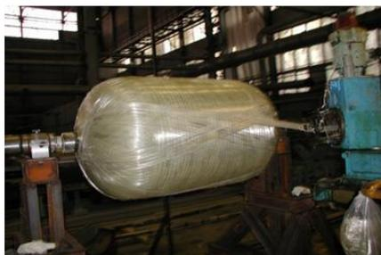
Рисунок 7.4 – Станок планетарного типа с совмещением привода вращения и шпуляника
