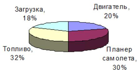
Рисунок 1.1 – Распределение массы снаряженного самолета
