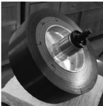
Рисунок 9.1 – Составной маятник, представляющий металлическую основу с композитной оболочкой
