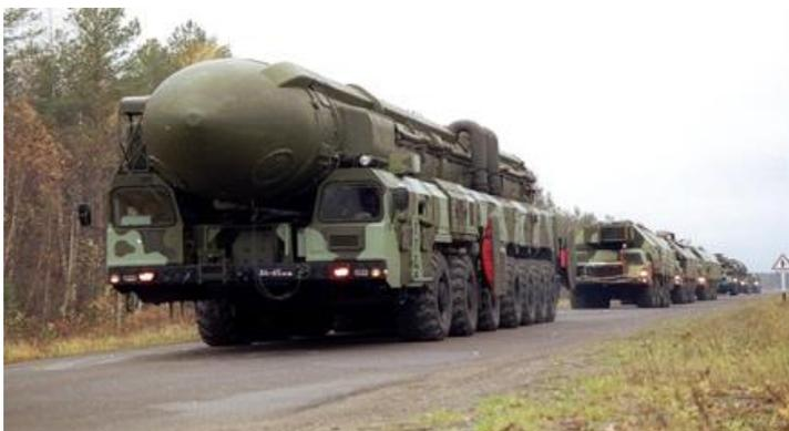
Рисунок 6.12 – Ракетный комплекс МБР “Ярс” с разделяемой головной частью на марше
