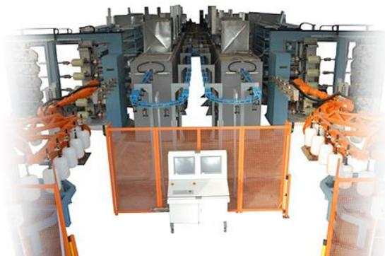
Рисунок 7.6 – Производственная линия фирмы Mikrosam для поточного изготовления баллонов высокого давления
