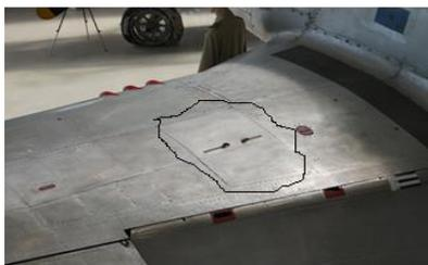
Рисунок 2.8 – Фрагмент крыла самолета и панель обшивки, подлежащая замене на композитную
