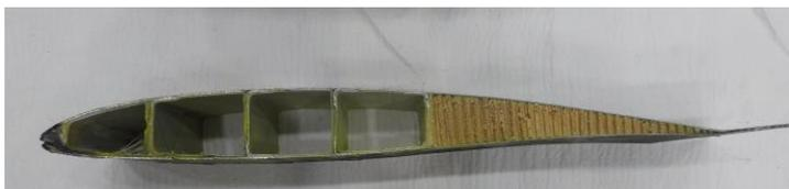
Рисунок 1.7 – Сечение лопасти винта вертолета из стеклопластика
