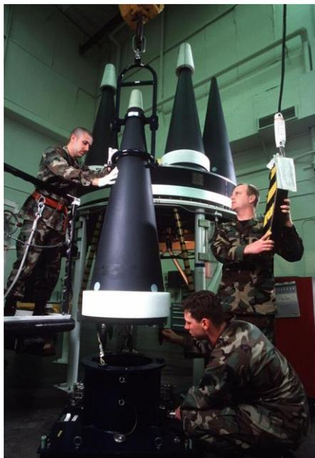
Рисунок 10.2 – Установка боеголовок в ступень разведения
