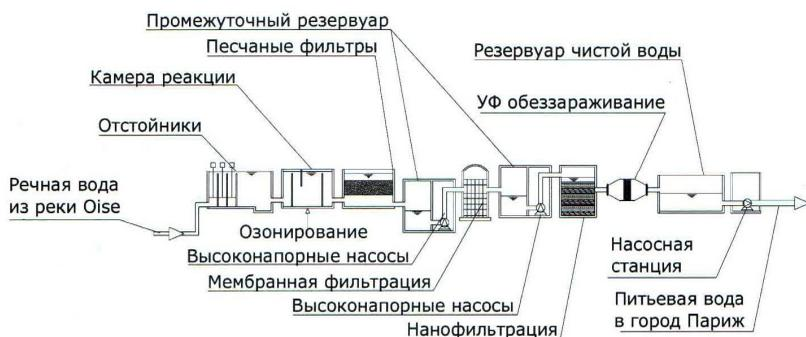
Рисунок 3.43 – Технологическая схема подготовки питьевой воды с использованием УФ установки
