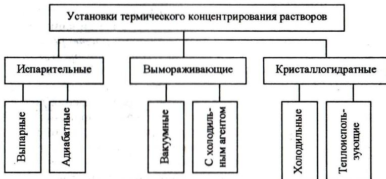
Рисунок 6.1 – Классификация установок термического концентрирования растворов
