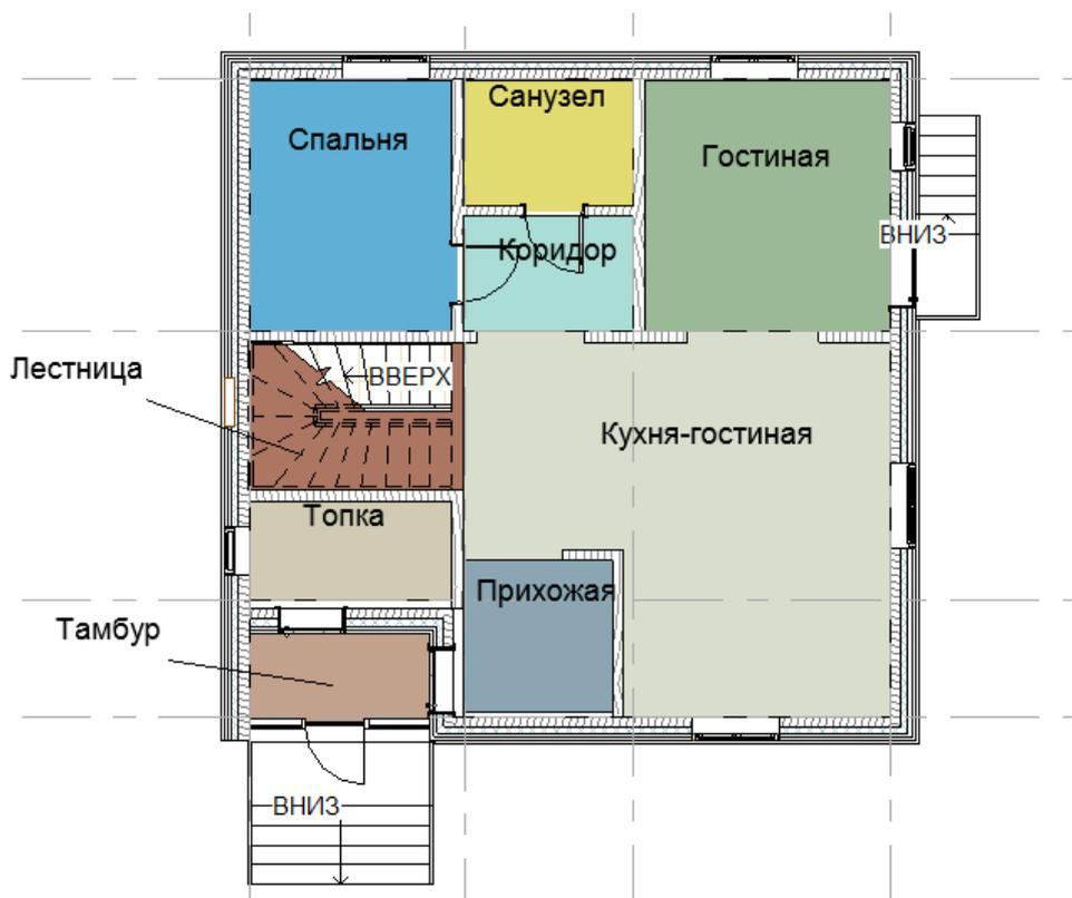
Рисунок 50 – Схема помещений 1-го этажа
