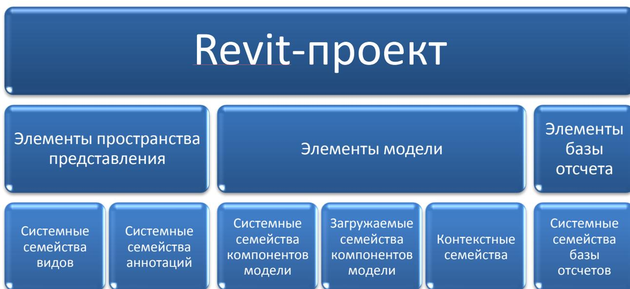
Рисунок 1 – Структура и элементы Revit-проекта
