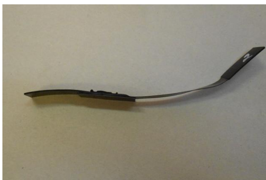
Рисунок 8 – Образец типа 3 из стыкового сварного соединения С3 после механического испытания
