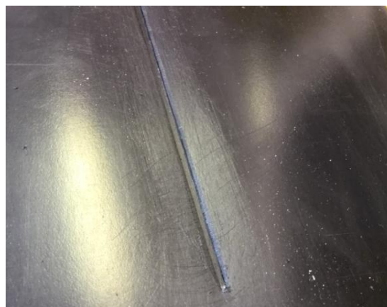
Рисунок 13 – Соединение С12 из листа толщиной 4,0 мм, собранное для сварки
