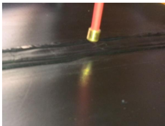
Рисунок 14 – Проверка герметичности С12 электроискровым методом
