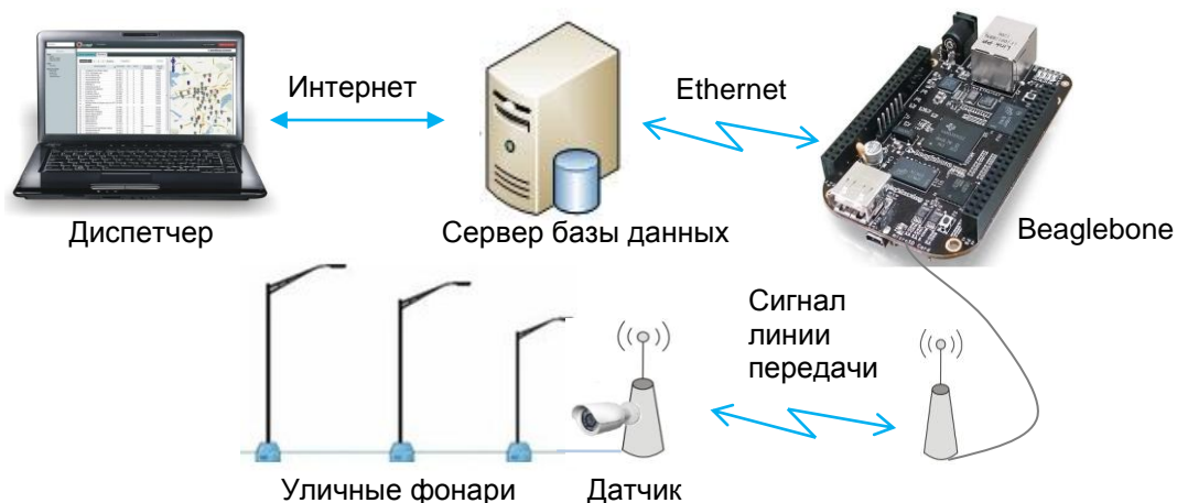
Рисунок 1 – Структура интеллектуальной системы освещения
