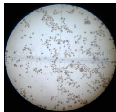
Рисунок 3 – Фотография осадков, полученных в процессе осаждения из хлормagneйевых рассолов при температуре осаждения 70 °С.
