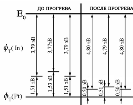
Рисунок 1 – Термоэлектронные работы выхода пленок индия (φ T (In)) до и после тепловой обработки при 723 К (φ T (Pt) = 5,3 эВ).
