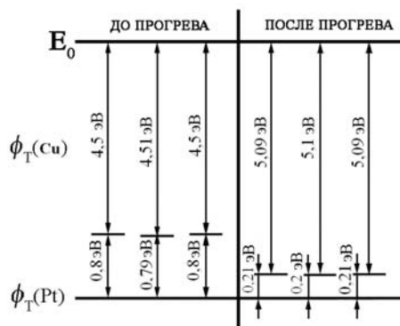
Рисунок 1 – Термоэлектронные работы выхода пленок меди ( \phi_T(\text{Cu}) ) до и после тепловой обработки при 473 К ( \phi_T(\text{Pt}) = 5,3 эВ).
