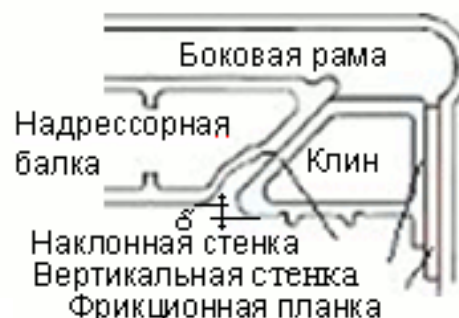
Рисунок 1 – Фрагмент фрикционного узла гашения колебаний тележки грузового вагона
