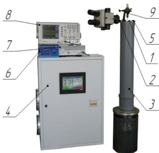
Рисунок 5 – Измерительный стенд, где 1 – ультразвуковая колебательная система, 2 – микрофон, 3 – технологический объём, 4 – ультразвуковой генератор, 5 – стробоскопическая система освещения, 6 – электронный генератор импульсов, 7 – генератор образцовой частоты, 8 – осциллограф, 9 – измерительный щуп
