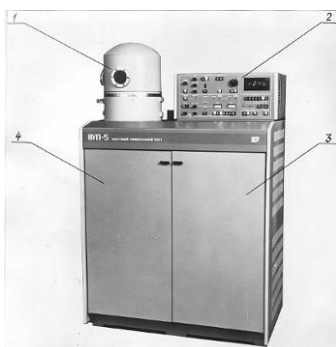
Рисунок 1 - Вакуумный универсальный пост (ВУП-5): 1 – рабочий объем для препарирования объектов; 2 – пульт управления и индикации режимов; 3 – блоки питания устройств и приставок; 4 – вакуумная система; 5 – предметный столик с сублимируемыми образцами; 6 – охладитель с жидким азотом
