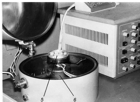
Рисунок 1 - Вакуумный универсальный пост (ВУП-5): 1 – рабочий объем для препарирования объектов; 2 – пульт управления и индикации режимов; 3 – блоки питания устройств и приставок; 4 – вакуумная система; 5 – предметный столик с сублимируемыми образцами; 6 – охладитель с жидким азотом
