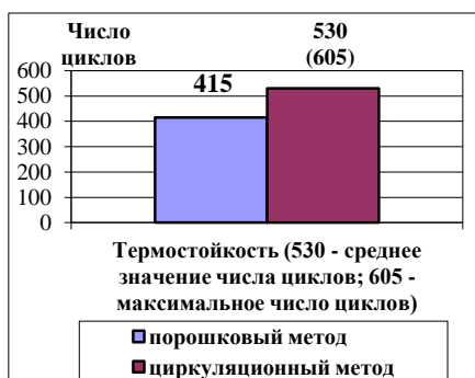
Рисунок 5 – Сравнение термостойкости хромоалитированных покрытий, полученных порошковым и циркуляционным методами на образцах и лопатках ГТД из сплава ЖС6У
