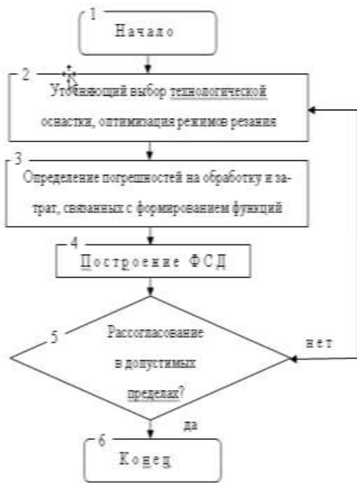
Рисунок 2 – Алгоритм выбора технологической оснастки и режимов резания
