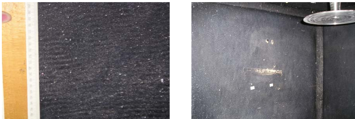
Рисунок 6. Фото стенки аэрозольной камеры после ультразвукового воздействия на аэрозоль (мучная пыль).
