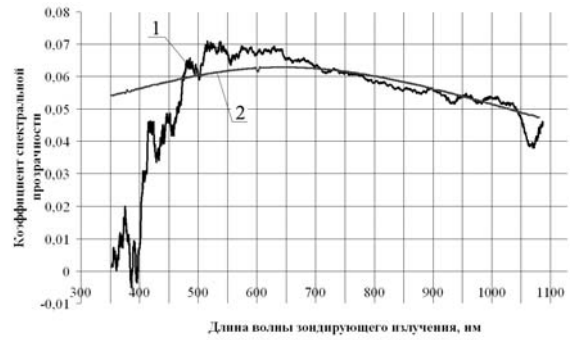
Рисунок 8. Экспериментальные и теоретические коэффициенты спектральной прозрачности: 1 – экспериментально полученные данные; 2 – теоретически полученные данные.
