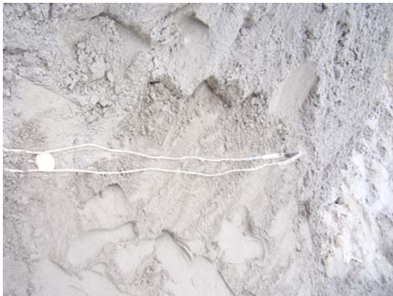
Рис. 8. Установка мессдоз в двух плоскостях
