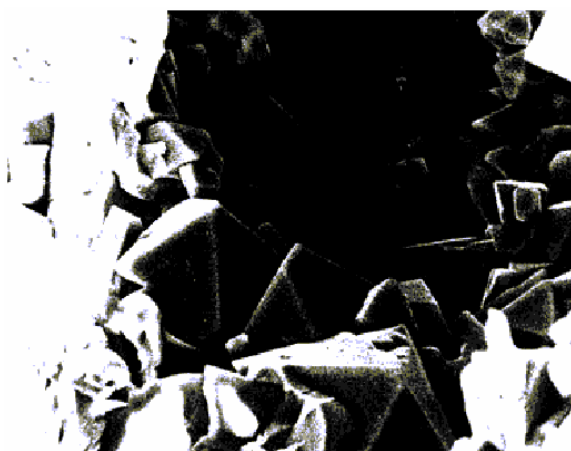
Рис. 3. Частицы оксида алюминия в структуре продукта взаимодействия в системе окалина легированной стали – алюминий (x2000)
