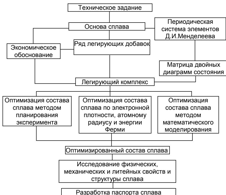
Рисунок 1 – Принципиальная схема синтеза сплава
