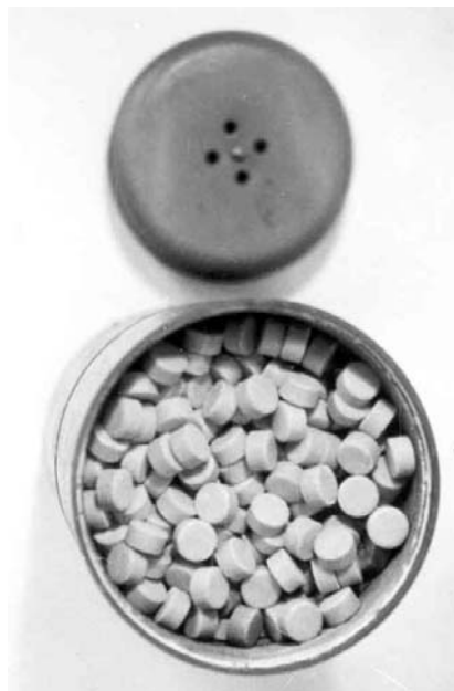
Рис. 2. Состояние образцов охладителя на основе мочевины после вскрытия газогенератора
