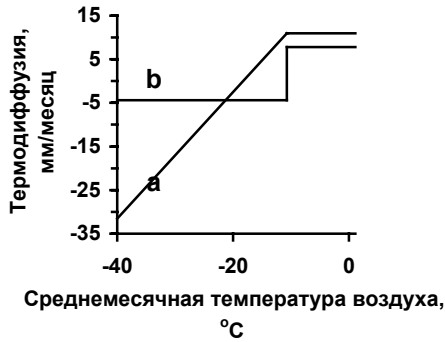
Рис. 2. Температурная зависимость термодиффузии влаги (>0 - приток, <0 - потери) из верхнего метрового слоя почвы в зимний период года при среднемесячных запасах продуктивной влаги этого слоя W < 139.6 мм (а) и W \geq 139.6 мм (б).
