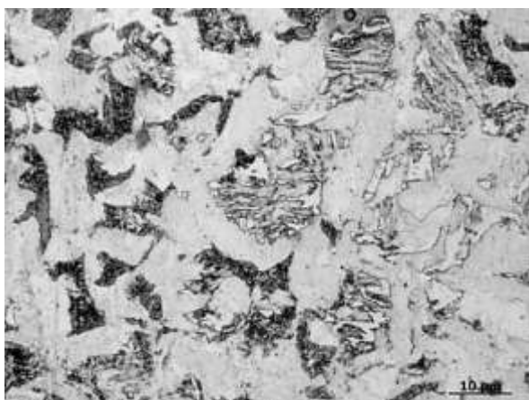
а) T = 940^{\circ}\text{C} , t = 30 мин, V = 6^{\circ}\text{C/сек} , KCV^{60} = 12,5 \text{ Дж/см}^2
