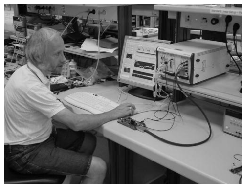
Рисунок 1 – Автоматизированная система измерений на базе NI PXI
