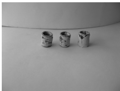
Рисунок 5 – Образцы с фосфатным покрытием после испытаний.
