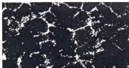
Рисунок 2 – Структура литой стали Р6М5 после 1 цикла (x400)
