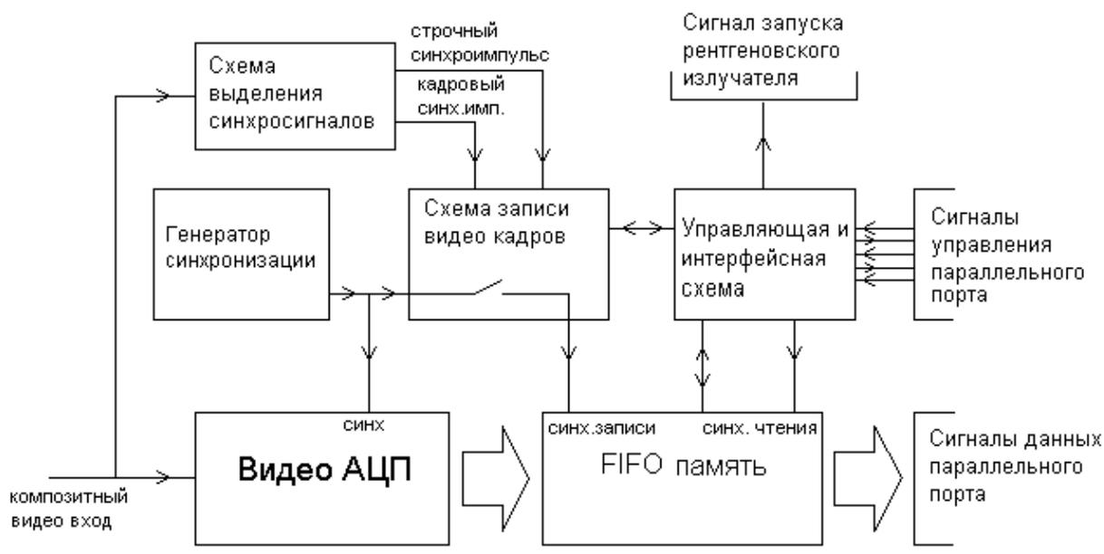
Рис.9. Функциональная схема блока записи видео изображений.
