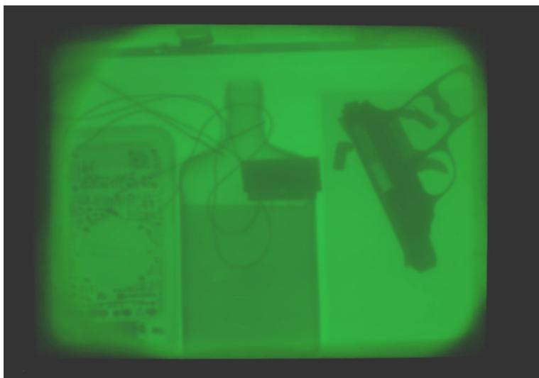
Рис. 7. Изображение содержимого портфеля, полученное с экрана ГРП.
