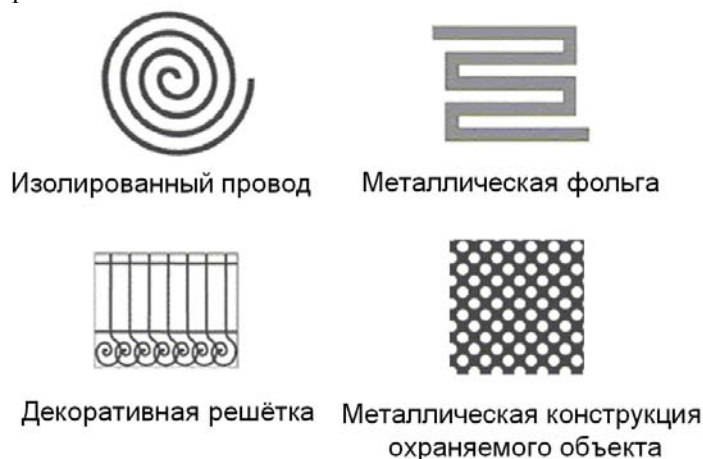
Рис.4. Металлические электроды, для которых проводился расчет емкости.
