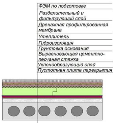
Рисунок 2 – Состав инверсионной эксплуатируемой кровли
