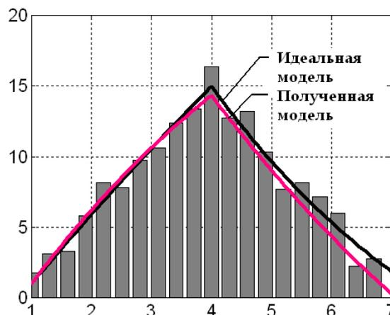
Рисунок 6 – Гистограмма зашумленных частот, данные по идеальной и полученной модели
