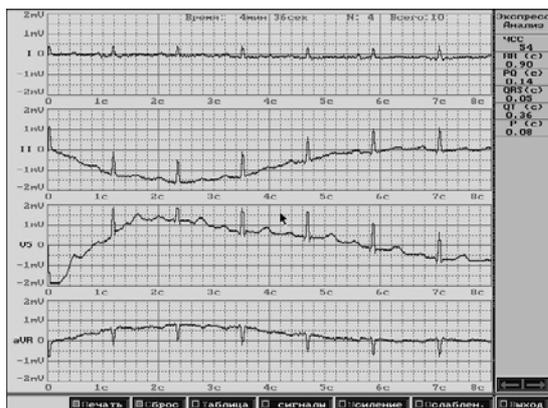
Рисунок 1 – Пример дрейфа изолинии при регистрации ЭКГ в велоэргометрии Кубический сплайн в области ST-сегментов существенно отклоняется от истинной изолинии сигнала.
