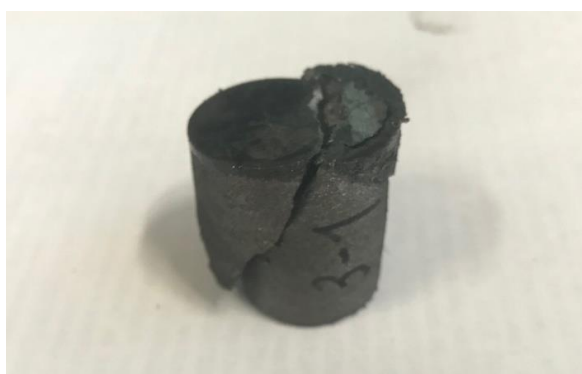
Рисунок 4 – Чугун ЧМН-35М образец 3-1
