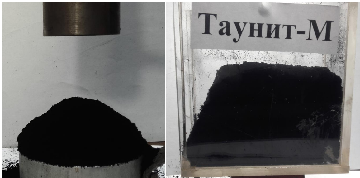
Рисунок 1 – Устройство для определения углов: а-естественного откоса; б-обрушения
