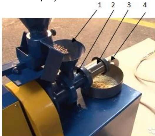
1 – загрузочный бункер, 2 – питающий корпус, 3 – прессующий корпус, 4 – гайка-матрица
