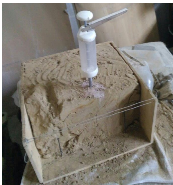
Рисунок 4 – Внедрение водной суспензии бурогоугольной золы в образец лессового грун- та ненарушенной структуры
