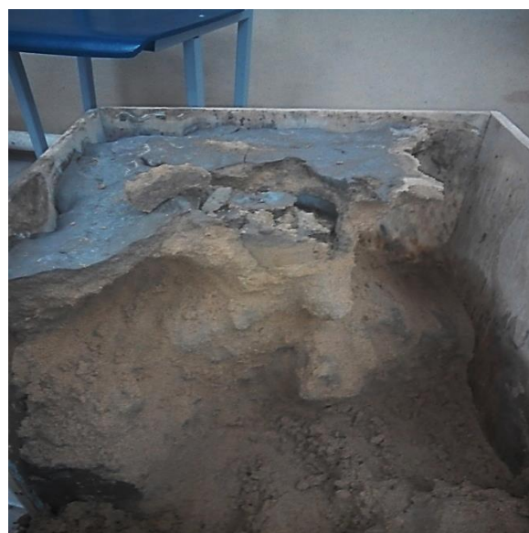
Рисунок 2 - Полученная область инъектирования
