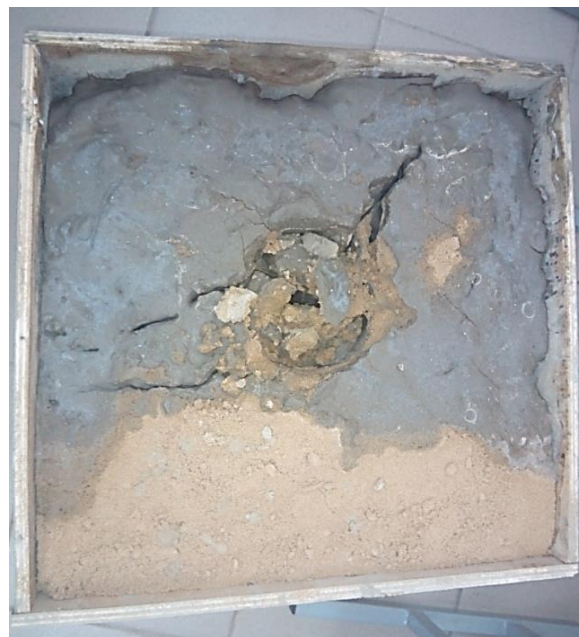
Рисунок 1 - Элементарный куб грунта после инъектирования
