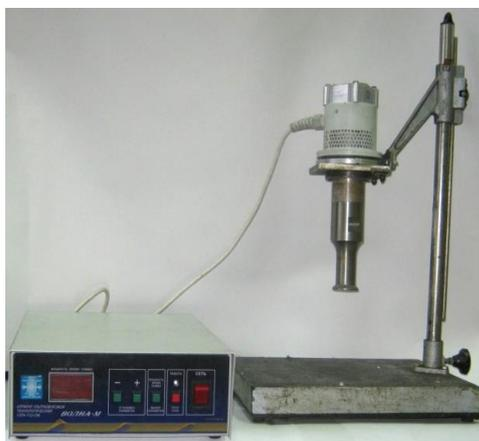
Рисунок 3 – Экспериментальный стенд для выявления зависимости объема зон развитой кавитации от расстояния между излучателем и отражающей границей
