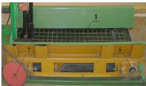
6 – натяжной барабан, 7 – ведущий барабан, 8 – лента конвейера
