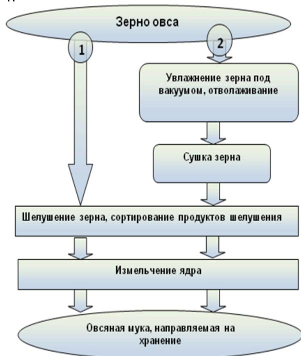
Рисунок 1 – Схема получения овсяной муки, направляемой на хранение
