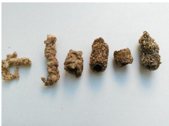
Рисунок 4 – Экструдат из высушенного измельченного картофеля
