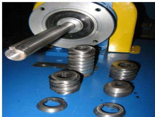
Рисунок 2 – Шнек экструдера в разобранном виде
